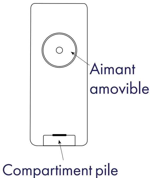
La télécommande possède 16 canaux pour piloter, au choix, 16 récepteurs ou 16 groupes de 10 récepteurs au maximum, suivant environnement, sachant qu'un groupe de 10 récepteurs peut-être appairé sur un même canal.
